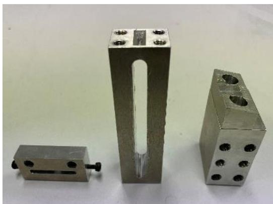
図-6 治具例. 左からトラス, 座屈, たわみ実験用
