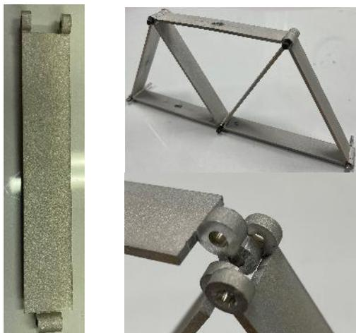
図-7 トラス試験体. 右上:連結したもの, 右下:ジョイント部
