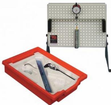
図-2 梁のたわみ実験キット<sup>2)</sup>
