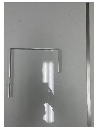
図-5 梁試験体(左)とラーメン試験体(右)
