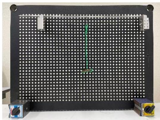
図-8 梁のたわみ実験の様子
