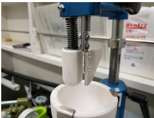
図-7 ダンシングミルの外観写真
