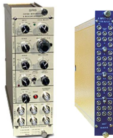
Fig.1 NIM モジュールの例
