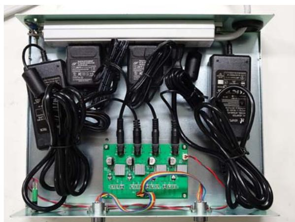
Fig.6 BIN 電源アダプタの内部
