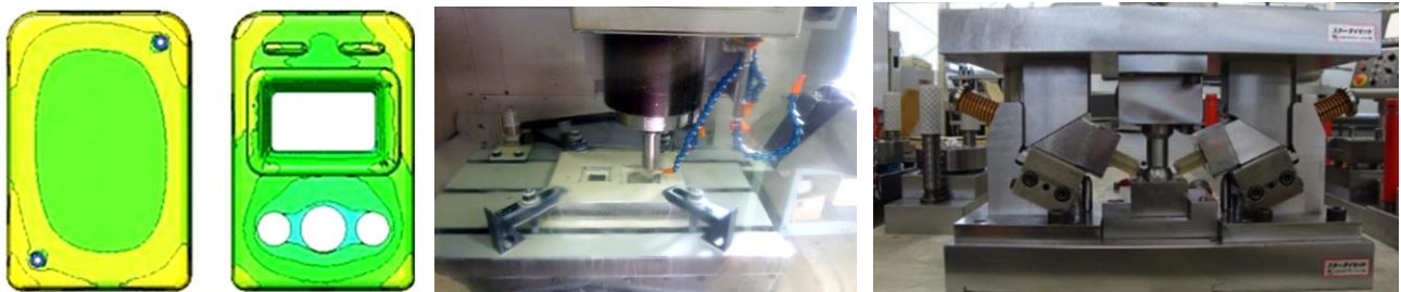
図 2 実践教育における射出成形の CAE, マシニング加工および完成したプレス金型
