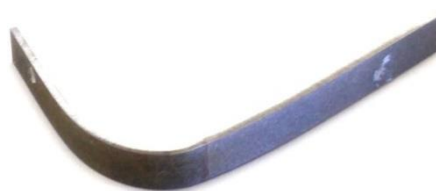
図10 曲げ試験(降伏強度の小さい軟鋼で変形)
