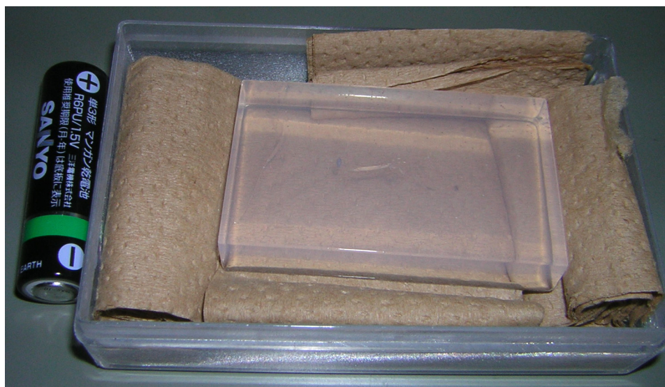
図11：屈折率1.2のエアロジェルのサンプル。
