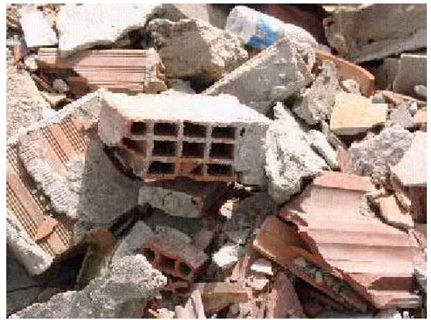
写真1 ツーラと呼ばれる中空レンガ。積み重ねられて無補強壁として用いられる。
