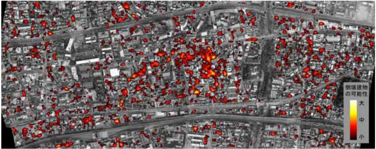
図 27 阪神・淡路大震災後の 1 日後に撮影された航空写真から被災地を推定した結果
