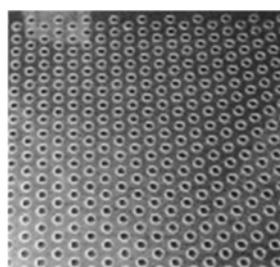
写真1：透明塩ビ製パンチングボード(穴の様子がわかりやすいように褐色の床面上に置いたもの)
