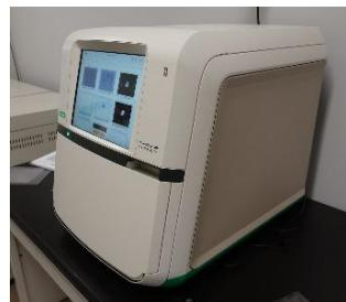
**粒子径分布測定装置**は、ナノ粒子や微粒子の特性評価を可能にします。分散液中の粒子、溶液中のペプチドや高分子を幅広い濃度範囲で測定することができ、サンプル調製にかかる時間を短縮することができます。Litesizer 500 は、3 つの測定角度で粒子径測定が可能です。また、Anton Paar 社独自の cmPALS 技術が搭載されており、低電圧でのゼータ電位測定を高い再現性と確度で実現します。
