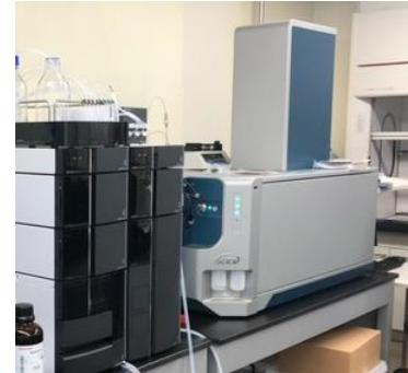
**LC-ESI MS (Triple Quad 3500 system)** は、LC で分離したサンプルを ESI 方式でイオン化し高精度で質量を観測できる装置。
