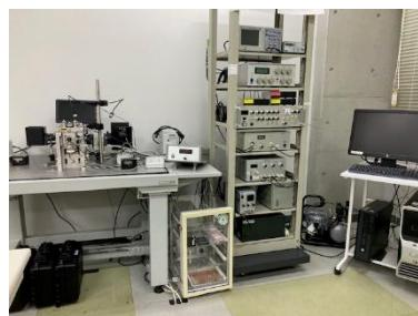
生体分子間相互作用解析システム (SPR) **Biacore T200** は、分子間相互作用を利用した測定の All-in-one システムで、フレキシブルかつ多様なアプリケーションに対応している。高い感度とさまざまな付加機能を有しており、1 台で分子間相互作用の特異性、アフィニティー、カイネティクス、濃度測定、低分子化合物測定および免疫原性試験が可能。相互作用メカニズムの解明に必要なサーモダイナミクスパラメーターも得ることができる。
