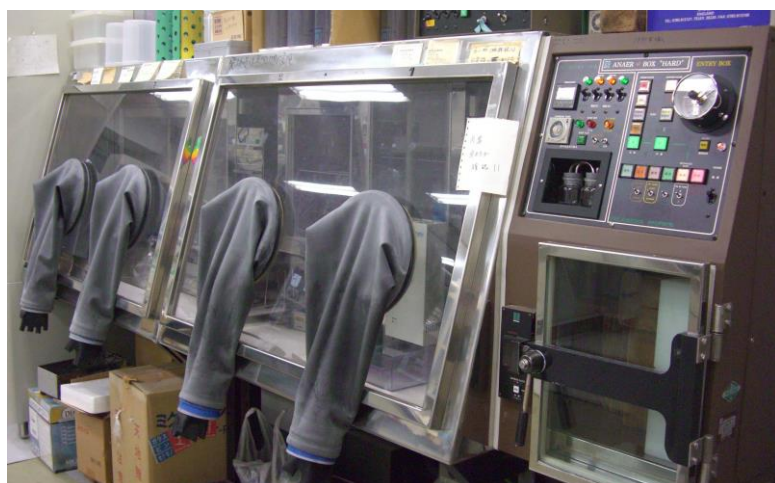
テーハー式アナエロボックス ANX-1W 【平沢製作所】
