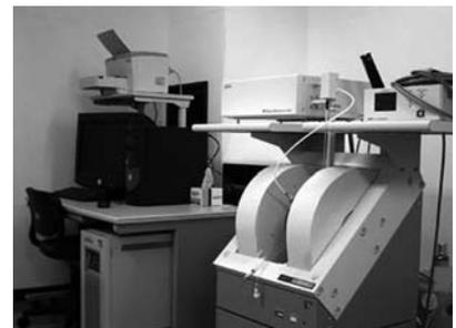
当分野の機種は、日本電子製 JES-FA100 シリーズのもので、フルコンピュータコントロール / Windows オペレーションの最新の ESR 装置である。従来の ESR 装置で、共振周波数を探し、フェーズとカップリングアイリスをマイクロ波のパワーを変えながら調整するのは、ある程度の慣れが必要だったが、JES-FA100 では、ジャストカップリングのためのマイクロ波調整は “AUTOTUNE” ボタンひとつで完了できる。また、Windows オペレーションの画面において、スペクトル取りこみ画面とデータ処理画面のシンプルに構成されている。取りこみ画面では、ESR 測定条件のほか、連続測定 - 自動保存、測定温度設定 (温度可変ユニットはオプション)、積算その他の取り込み条件を各ウィンドウから設定できるようになった。
