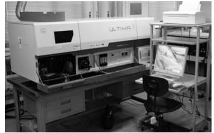
ICP では、高周波の誘導コイルを使用してアルゴンガス流中に6,000~10,000Kの温度に加熱されたアルゴンイオンを作る (誘導結合プラズマ、ICP)。その高温プラズマが原子の励起を促進し、測定感度を向上する。そのため、測定条件を変更することなしに、1 ppb 以下の極微量から1,000ppm またはそれ以上の濃度範囲にある元素を検出可能である。また、高い温度の励起源を用いることで、ほとんどすべての化合物をその構成元素に分解することができるため、他の原子スペクトル法で問題となっていた共存物質の影響や、分子種由来のバックグラウンドの影響を大幅に低減することができる。
