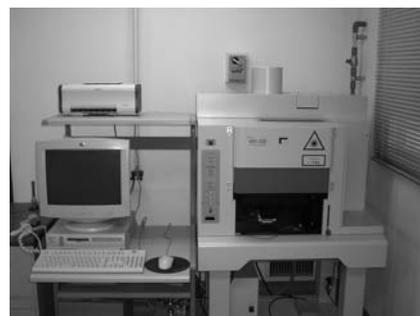
当分野は日本分光（株）製 NRS-1000 シリーズ高感度・小型顕微ラマンシステムを所有している。装置の特徴として以下の5つを挙げることができる。①励起レーザー波長は532 nm で、安定的に使用できるように空冷、100V の電源を使用されている。②レーザー光に対する安全対策としてクラス I（JIS 規格）相当でインターロックシステムに対応している。③高感度冷却型 CCD 検出器が搭載されており、532 nm 励起でラマンシフト値は100～8,000  $\text{cm}^{-1}$  の範囲で測定可能である。④試料室は、マイクロ（後方散乱）とマクロ（擬似後方散乱）の測定に両方対応でき、サンプルを設置したら、切替で両方の測定ができる。⑤内蔵 CCD とビデオキャプチャーにより試料の観察、レーザースポット、アパーチャ像を CRT モニター上に表示することができ、共焦点光学系により最小1 μm までの試料を測定することができる。
