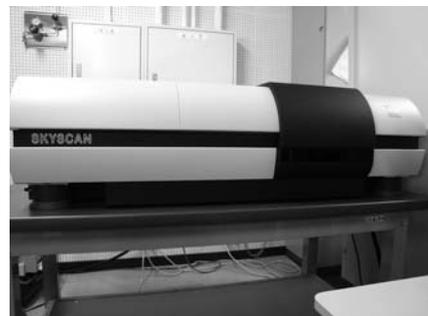
回転した時に測定範囲からはみ出ないことを確認すれば、あとは測定開始のコマンドをクリックするのみである。得られたデータの再構成は標準装備の NRecon ソフトウェアか高速再構成ソフトウェアの Instarecon により短時間で行うことができる。Instarecon ソフトウェアを使用すると 1K × 1K のデータが約 25 秒で再構成可能であり、再構成されたスライスデータは BMP、TIF、JPG 等のフォーマット及び数値データフォーマットで保存できる。定量解析ソフトウェアも充実しており、CT-Analyzer を用いると、空隙、パーティクルの分布、体積や表面積計算を行うことができる。また、3つの直交象限を同時に表示する Data Viewer では任意の断面情報を観察でき距離を測定出来る。
