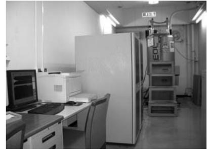
固体 NMR 測定ユニット (NM-93030CPM) / プローブ：4 mm 径、CP / MAS プローブ / 観測核 (プローブ)： $^1\text{H}$ 、 $^{15}\text{N}$ 、 $^{29}\text{Si}$ ～ $^{31}\text{P}$
