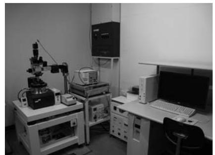
本システムは装置制御とデータ処理を行うプローブステーションおよび2台の測定ユニット、高精度大型プローブ顕微鏡ユニット AFM5400L と環境制御型ユニット AFM5300E からなる。AFM 測定など多くは両方のユニットで測定可能だが、電気化学
