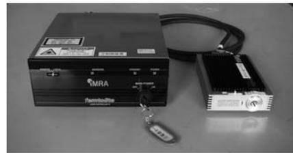
は商用 AC100V のみ、冷却水等は不要で、レーザーヘッドと制御装置のみで動作する。基本的に調整箇所と消耗品が無く、メンテナンス・フリーである。寸法はレーザーヘッドが  $145 \times 98 \times 40$  mm、制御装置が  $200 \times 215 \times 89$  mm で、質量は合計約 3 kg と小型で可搬である。同期信号出力端子 (SMA) より、レーザー繰り返し周波数に同期した電気パルス信号が出力されている。リモートコントロールコネクタを介して、レーザー出停止、インタロック、レーザー出射状態のモニターができる。
