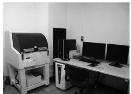
AFM・STM、真空中および温度制御には AFM5300E を用いる必要がある。それぞれ、光学顕微鏡を備え、装置の調整、試料の位置合わせが容易にできる。データ処理部は高速フーリエ変換 (FFT) を始めとする各種のフィルタおよび画像解析プログラムをもち、視覚に訴える 3 次元画像を作成することができる。
