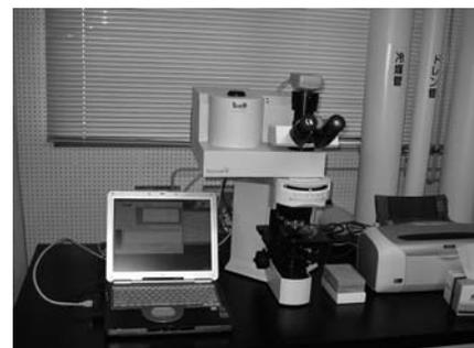
要ない（通常の反射測定モードもある）。また、測定部はダイヤモンドを通して直接目視することができるため正確な位置情報が得られ、またその映像は CCD カメラによりデジタルデータとして保存もできる。WindowsXP 上で動作する簡単なオペレーティングソフトウェアで操作できるので、初心者でもすぐに使いこなすことができる。
