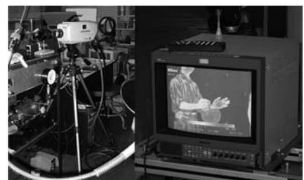
fは焦点距離)で、最短撮影距離0.5 mとなっている。出力はNTSC、RS232C、NIKON専用デジタルコネクタと三種類可能。冷却方式はスターリングクーラ(つまり液体窒素などの供給は不要)で、傾斜使用制限が液体窒素使用と比較して大幅に緩い。
