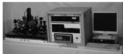
オザワ THz-TDS の特徴を以下に記す。標準的には透過型のテラヘルツ分光走査型顕微鏡であるが、光学系の配置と制御ソフトウェアによって、空間分解の要/不要、透過型/反射型の計測ができる。具体的には、試料によって、空間分解しない/2次元走査/3次元走査と透過/反射が選択できる。光学系の配置を変更する際にはレーザーの精密な調整 (< 10 μm) が必要となるが、その為のレーザーのアライメントモジュールが用意されている。
