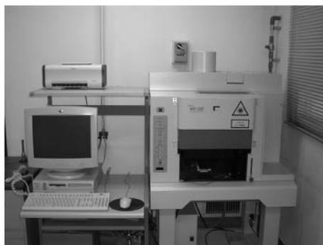
当分野は日本分光（株）製 NRS-1000 シリーズ高感度・小型顕微ラマンシステムを所有している。装置の特徴として以下の 5 つを挙げることができる。①励起レーザー波長は 532 nm で、安定的に使用できるように空冷、100 V の電源を使用されている。②レーザー光に対する安全対策としてクラス I（JIS 規格）相当でインターロックシステムに対応している。③高感度冷却型 CCD 検出器が搭載されており、532 nm 励起でラマンシフト値は  $100 \sim 8,000 \text{ cm}^{-1}$  の範囲で測定可能である。④試料室は、マイクロ（後方散乱）とマクロ（擬似後方散乱）の測定に両方対応でき、サンプルを設置したら、切替で両方の測定ができる。⑤内蔵 CCD とビデオキャプチャーにより試料の観察、レーザースポット、アパーチャ像を CRT モニター上に表示することができ、共焦点光学系により最小  $1 \mu\text{m}$  までの試料を測定することができる。
