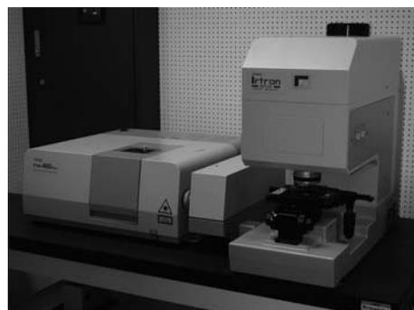
CRT 上でサンプルの測定部位を確認できる CCD カメラシステムが内蔵され、マウス操作によりアパーチャの開口面積や角度を自由に制御できるなどの特徴を有しており、初心者でも容易に測定を行える。赤外顕微鏡ユニット IRT-30は透過、反射の測定モードでの測定が可能で、特に透過性の低い金属や無機焼結体などの試料あるいは微量成分の検出に適している。また、試料ステージを1次元あるいは2次的に駆動させ、多点のスペクトルを測定することによって、特定官能基の分布を捕らえることができる。
