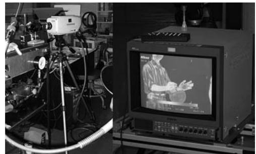
方式はスターリングクーラ (つまり液体窒素などの供給は不要)で、傾斜使用制限が液体窒素使用と比較して大幅に緩い。
