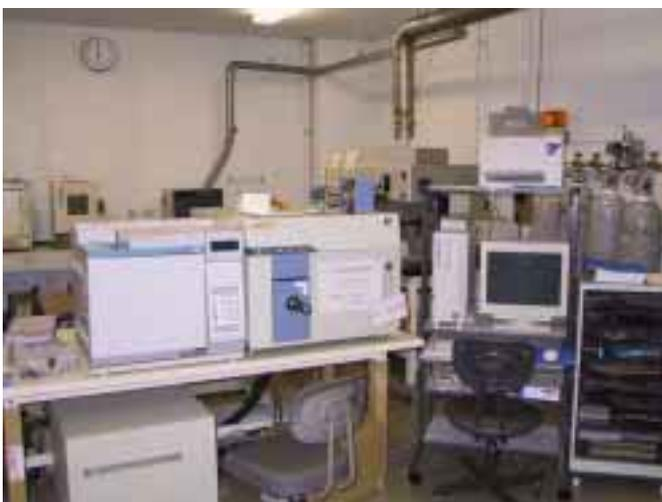
全自動測定、特にルーチン分析の自動化を対象に設計・開発されたベンチトップタイプの GC MS システムである。分析系は小形でユニークな二重収束光学系を基本に、精密質量測定と簡易操作を両立させている。さらに最新の OS (Windows) を採用して、すべてのオペレーションは、コンピュータコントロールされ、イオン源 / 分解能の設定からチューニング・測定・プリントアウトまで全自動で行える。
