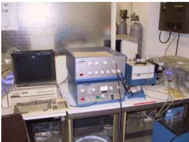
化学反応は一般に非常に速い過程であることが多く、そのような反応のメカニズムの解明にはストップフロー法や緩和法が用いられる。ストップフロー法は、ピストンを素早く引いた後止めることで、2種の溶液を能率よく混合した後、流れをせき止め、測定セル内で進行する反応を、例えば吸収スペクトルの時間変化で追跡し、反応速度定数、反応中間体の生成や消失の速度定数等を求める方法である。これに対して、観測セル内の平衡にある反応系溶液に対してその温度を急速に上昇させる温度ジャンプなどによってその平衡を乱し、その後反応系が新しい平衡に向かって移行する過程を追跡するのが緩和法である。この方法では、緩和時間に関する情報が得られ、別の実験で求めた平衡定数の情報と組み合わせることにより反応速度定数を知ることが出来る。
