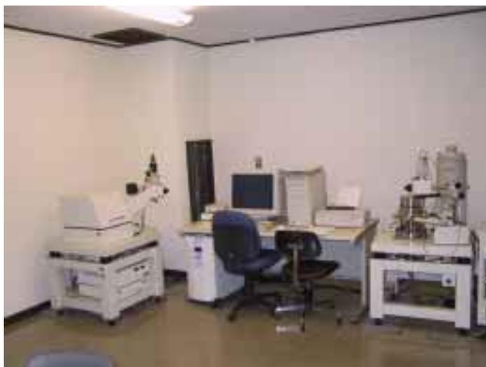
走査型プローブ顕微鏡 (SPM) は、測定試料と探針間に働く原子間力またはトンネル電流を検出することにより、試料の表面のミクロな部分の形状、摩擦などの情報を得るものである。当センターの走査型プローブ顕微鏡はセイコーインスツルメンツの SPI3800 で、試料の大きさは 45 mm x 45 mm x 5 mm 程度、面内に 0.2 nm、垂直方向に 0.01 nm の装置分解能をもち、条件によっては原子レベルの観察もできる。ユニットの交換により、原子間力顕微鏡 (AFM)、走査型トンネル顕微鏡
