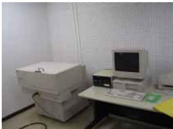
物質による紫外及び可視領域 (約 200-700 nm) の光の吸収はその分子内の電子構造に依存しており、電子が基底状態における軌道から高いエネルギーの軌道へ遷移することによりおこる。例として、遷移金属化合物における d - d 遷移や二重結合を有する有機化合物の $\pi$ - $\pi^*$  があげられる。そのため、紫外可視吸収スペクトルからそのような化合物の同定や定量が、さらには未知化合物
