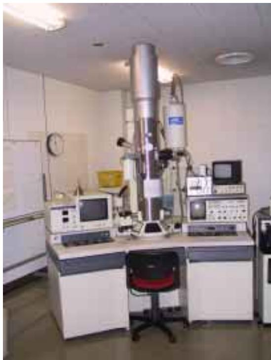
当センターに設置されている電子顕微鏡は、日立製の本体 H-8100 に付属装置として走査像観察装置 H-8010，エネルギー分散型 X 線分析装置 Analyst 8000 (Kevex 社) と電子線エネルギー分析装置 H-8020 を装着しており、医学生物科学および材料科学における試料の総合的分析が可能になっており、下記のような分析が日常的に行われている。
