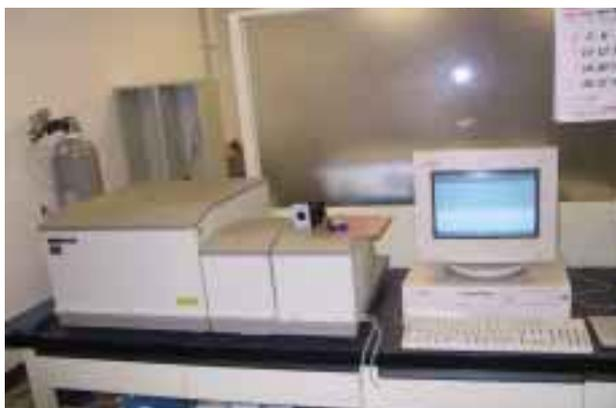
物質による赤外線 (約  $5000 \sim 300 \text{ cm}^{-1}$ ) の吸収はその分子の振動構造に依存しているが、1個の振動エネルギーの変化に伴って多数の回転エネルギー変化が起こるので、振動スペクトルは振動吸収“帯”として現れる。吸収の振動数あるいは波長は、振動部分の換算質量、化学結合の力の定数および原子の幾何学的配置に依存する。したがって、赤外スペクトルから分子構造を解析することができる。
