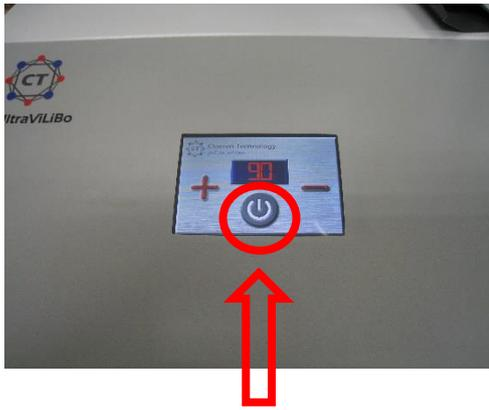
8. タッチペンで数字の下のマークを押すと UV 照射が始まり, カウントダウンされる
