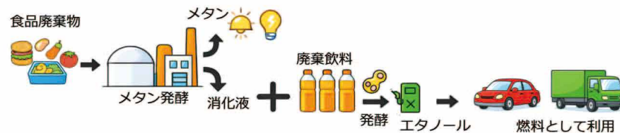
図2 目標とするプロセス：メタン発酵とエタノール発酵を利用した物質循環社会
