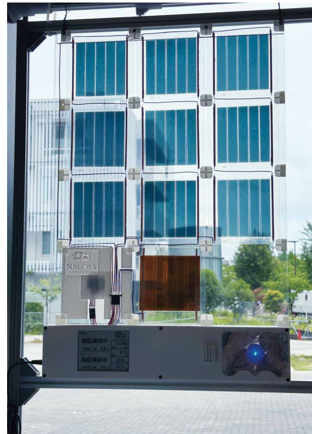
カーボンナノチューブ電極を用いた太陽電池（NIC館ガラス面に設置。CNT-OPV9枚、CNT-PSC1枚。2025年3月11日から開始。）
