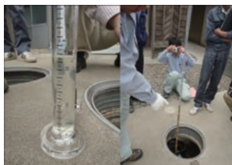
浄化槽からの採水と透視度測定の様子
