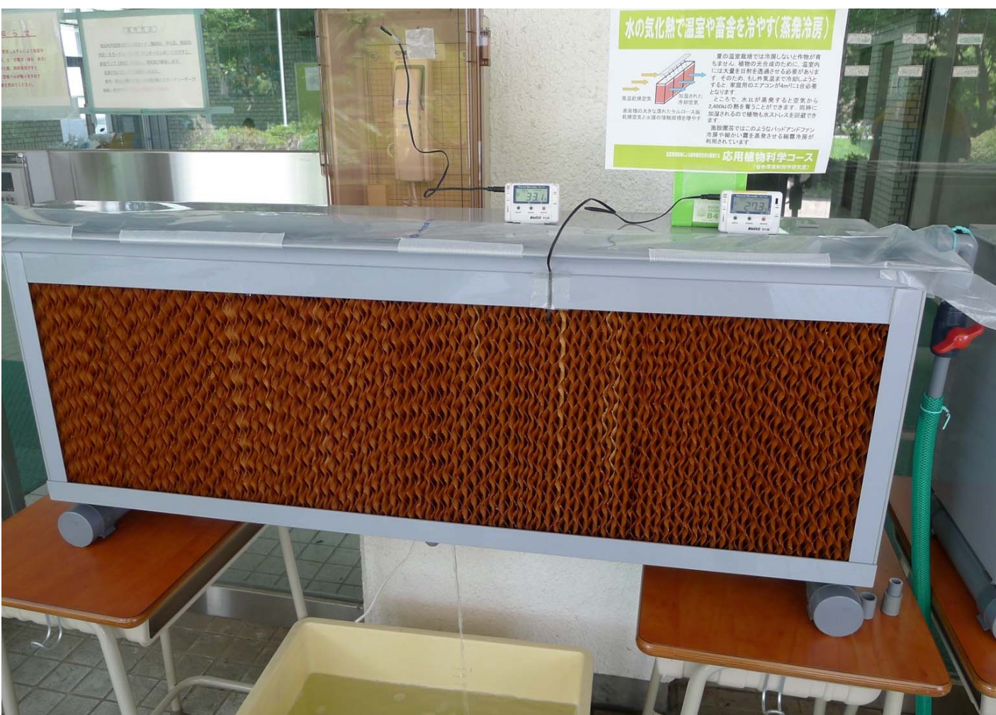
気化冷却を利用した冷房装置 (簡易設置型パッド&ファン)
