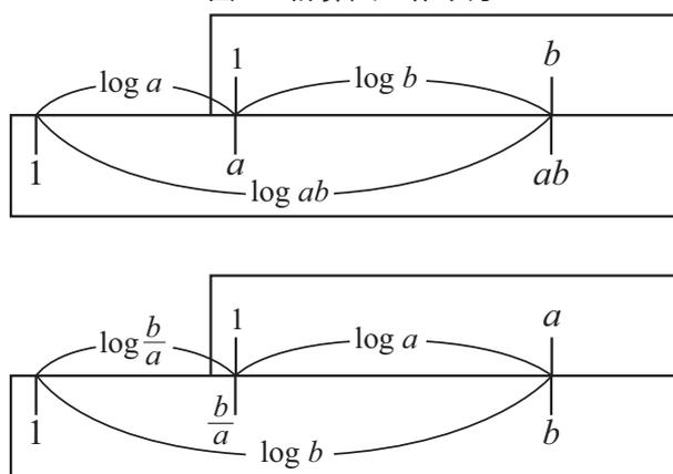
図5 計算尺の仕組み
