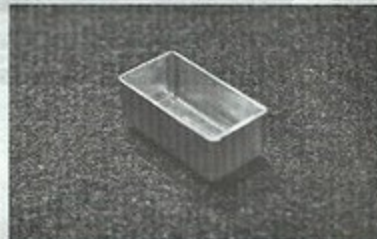
岐阜大学が製作したプレス金型、角絞り品
