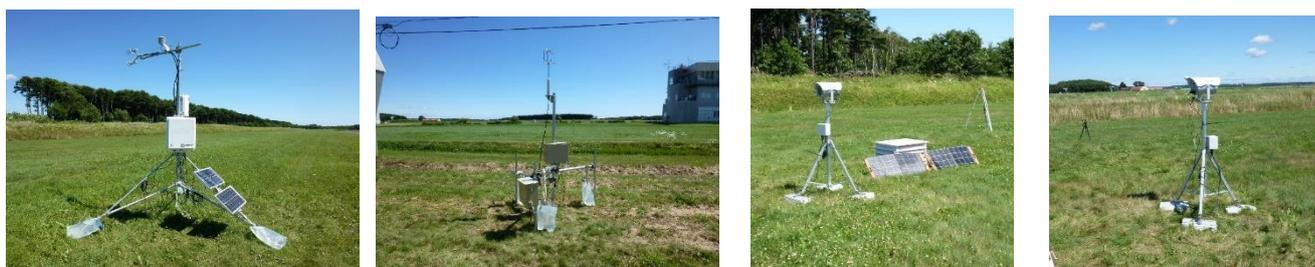
図2 表1の計測機器の観測当日の様子、左から、IRGASON, Windmaster2, LAS MkII(送信側)、LAS MkII(受信側)ただし受信側のソーラーパネルと電源装置(百葉箱様の箱内)は写っていない。
