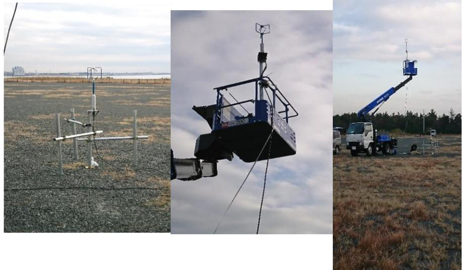
図1 超音波風速温度計の設置状態。左 地上の超音波風速温度計、中 高所作業車上の超音波風速足温度、右 観測点遠景
