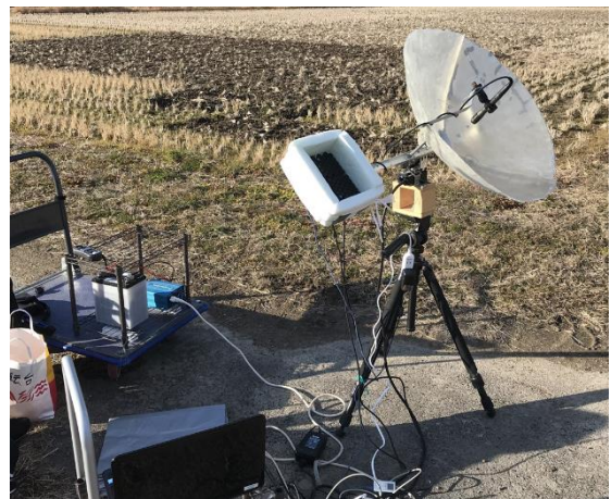
図1 本年度製作したドップラーソーダ。パラボラは直径70cmで、中心部にマイクを持つ受信部で、その左の四角いものが、パラメトリックスピーカに、サイドロブ対策の吸音材のカバーを付けたものである。
