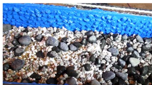
写真-2 混合土砂及び粗度板設置状況
