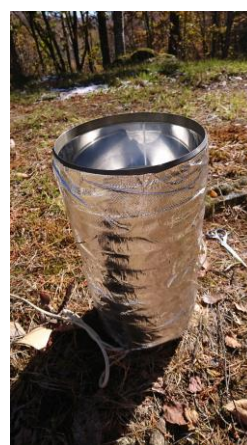
図1 水道用凍結防止ヒーターを巻いた雨量計（CTKF-1-UD）
