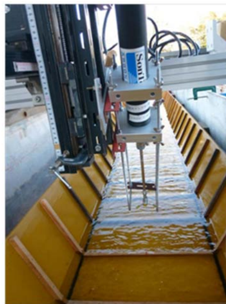
図 1 Micro ADV と台形断面水路
