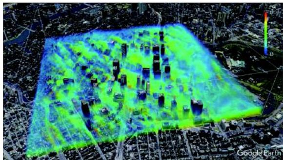
図1 東京都心部を対象とした建物解像シミュレーションによって得られた2015年8月7日14:30の気温分布
