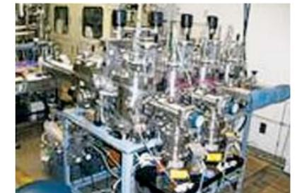
図：太陽電池作製装置
