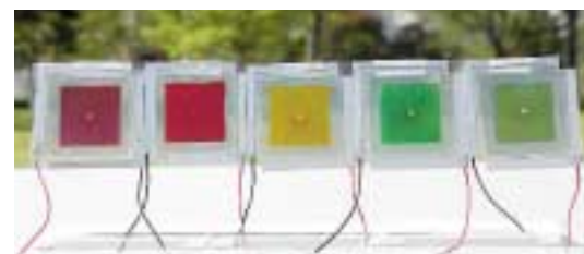
図1 PETフィルム状カラフル太陽電池
