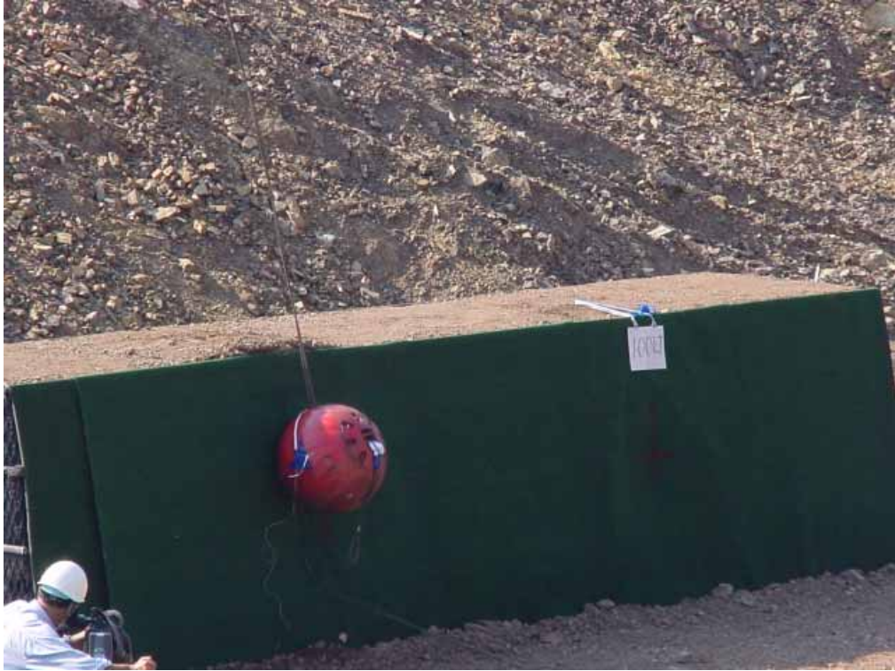
堤防型補強土防護壁の変形
