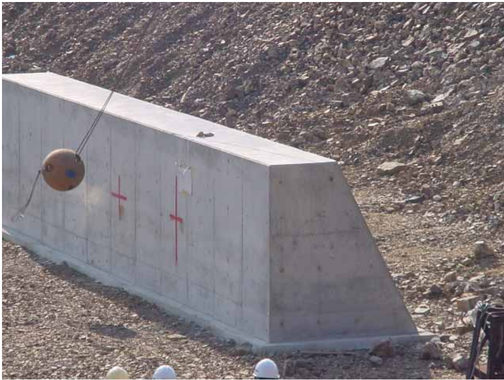
コンクリートブロック衝突直後
