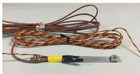
写真-2.1 埋設ひずみゲージと熱電対
