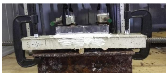
写真-1 曲げひび割れを導入した供試体
