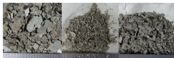
写真-1 採取したスケーリング片(左から普通コンクリート, PVA シリーズ, PET シリーズ)
