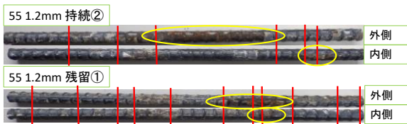
図-8 鉄筋の腐食状況とひび割れ位置の例 (—: ひび割れ位置, ○: 腐食の範囲) (上/持続荷重供試体—試験期間 3 か月, 下/残留ひび割れ供試体—試験期間 3 か月)
