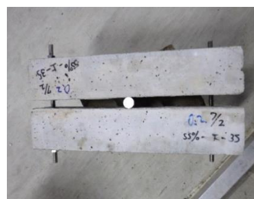
写真-1 ひび割れ幅調整後の供試体
