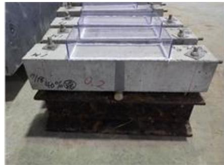
写真-1 持続荷重供試体の準備
