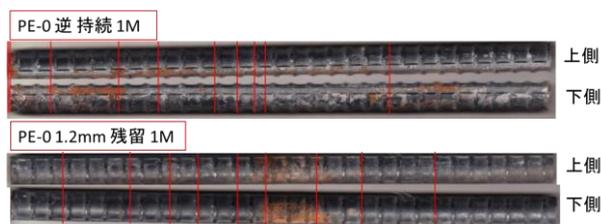
**写真-3 鉄筋腐食の様子とひび割れ位置の関係の例**
