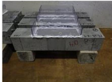
写真-2 残留ひび割れ供試体の準備
