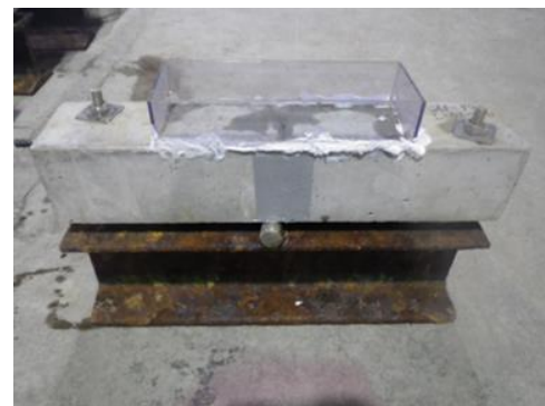
写真-1 持続荷重供試体の準備
