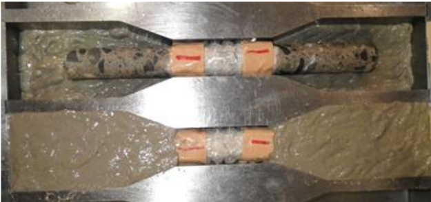
写真-3 ダンベル型供試体への後成形の例
