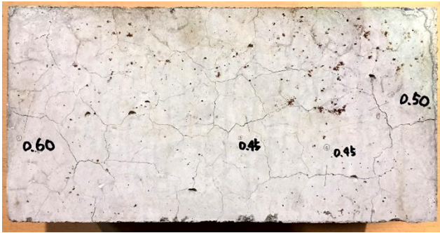
写真-4 ASR 供試体ひび割れ様子
