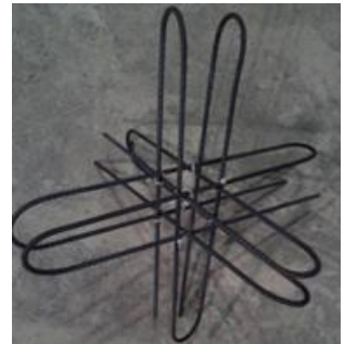
写真-5 内部鉄筋形状
