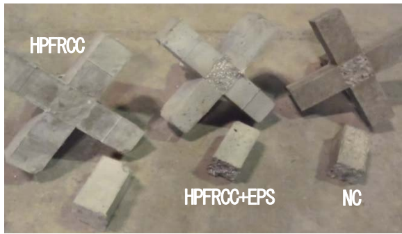
写真-10 無筋立体十字供試体試験終了時の破壊性状
