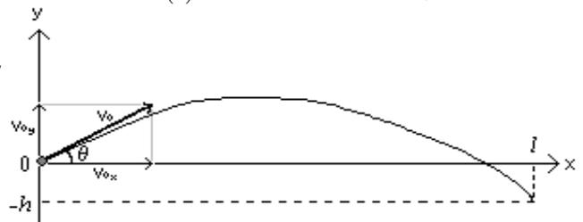
水平方向, 垂直方向について, i) と同様に考えればよいので, 時刻  $t$  におけるボールの位置は,  $(v_0 t \cos \theta, -\frac{g}{2} t^2 + v_0 t \sin \theta)$ , 速度ベクトルは,  $\vec{v}(t) = (v_0 \cos \theta, v_0 \sin \theta - gt)$  である。
