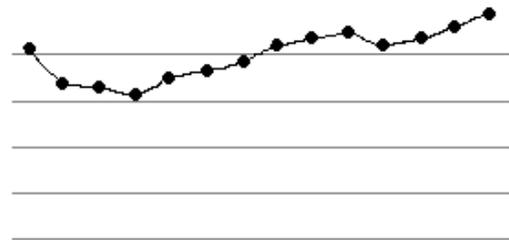
グラフの左端に扇風機があり, 右に行くに従って扇風機から遠ざかっている。この図から, 扇風機より少し離れたところに一番風が強く当たっていることが分かる。この実験結果を, 数式を用いて再現しよう。
