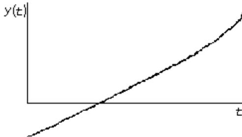
つまり, 直線に近い曲線になる。  $t$  が 0 に近いとき, グラフが  $t$  軸の下にあるのはまだ水が空中に浮かんでいる状態に対応する。実際のその部分での  $y(t)$  の値は 0 である。
