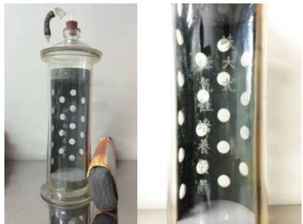
岐大式嫌気培養ジャー (黎明期に開発された嫌気ジャー1960～70頃?)
