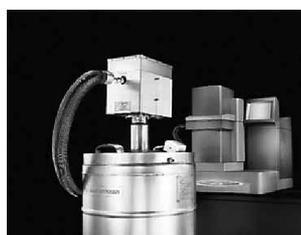
ガスクーリングアクセサリ (GCA) を使用すると $-150^\circ\text{C}$ の低温まで測定できるようになります。GCAは液体窒素冷却方式で正確な温度コントロールを可能にします。GCAは、タンク内の液体窒素量が減少すると測定完了後に自動的に液体窒素を補充するので、液体窒素切れのために測定が途中で停止することはありません。DMA Q800KGはGCAを使用することにより $-150\sim 600^\circ\text{C}$ の全温度範囲にわたる測定ができます。
