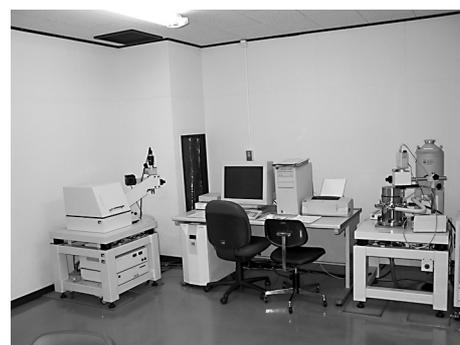
本システムは装置制御とデータ処理を行うプローブステーションおよび2台の測定ユニット、多機能型ユニット SPA400と環境制御型ユニット SPA300V からなる。AFM 測定など多くは両方のユニットで測定可能だが、電気化学 AFM・STM は SPA400で、真空中および温度制御には SPA300V を用いる必要がある。それぞれ、光学顕微鏡を備え、装置の調整、試料の位置合わせが容易にできる。データ処理部 (DELL OptiPlex GXa、DOS/V、Windows95) は高速フーリエ変換 (FFT) を始めとする各種のフィルタおよび画像解析プログラムをもち、視覚に訴える3次元画像を作成し、フルカラーでプリント (EPSON PM-750C) することができる。
