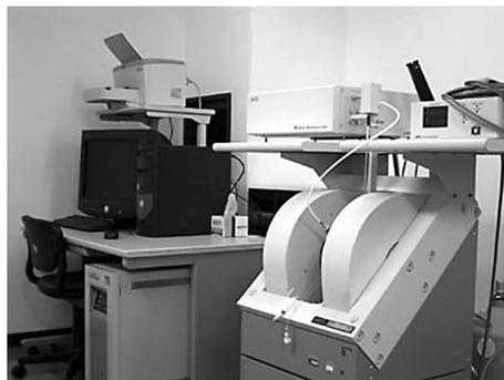
当分野の機種は、日本電子製 JES-FA100シリーズのもので、フルコンピュータコントロール/Windows オペレーションの最新の ESR 装置である。従来の ESR 装置で、共振周波数を探し、フェーズとカップリングアイリスをマイクロ波のパワーを変えながら調整するのは、ある程度の慣れが必要でしたが、JES-FA100では、ジャストカップリングのためのマイクロ波調整は“AUTOTUNE”ボタンひとつで完了できる。また、Windows オペレーションの画面において、スペクトル取りこみ画面とデータ処理画面のシンプルに構成されている。取りこみ画面では、ESR 測定条件のほか、連続測定—自動保存、測定温度設定（温度可変ユニットはオプション）、積算その他の取り込み条件を各ウィンドウから設定できるようになった。
