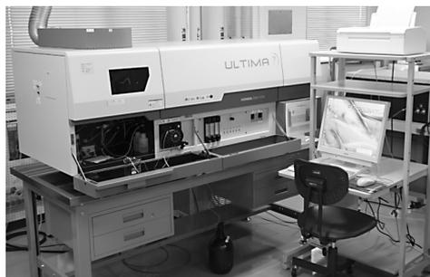
ICPでは、高周波の誘導コイルを使用してアルゴンガス流中に6,000–10,000Kの温度に加熱されたアルゴンイオンを作る（誘導結合プラズマ、ICP）。その高温プラズマが原子の励起を促進し、測定感度を向上する。そのため、測定条件を変更することなしに、1 ppb 以下の極微量から1000ppm またはそれ以上の濃度範囲にある元素を検出可能である。また、高い温度の励起源を用いることで、ほとんどすべての化合物をその構成元素に分解することができるため、他の原子スペクトル法で問題となっていた共存物質の影響や、分子種由来のバックグラウンドの影響を大幅に低減することができる。
