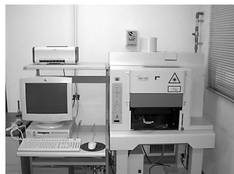
装置の特徴として以下の5つを挙げることができる。①励起レーザー波長は532nmで、安定的に使用できるように空冷、100Vの電源を使用されている。②レーザー光に対する安全対策としてクラスI (JIS規格) 相当でインターロックシステムに対応している。③高感度冷却型 CCD 検出器が搭載されており、532nm 励起でラマンシフト値は $100\sim 8000\text{cm}^{-1}$ の範囲で測定可能である。④試料室は、マイクロ (後方散乱) とマクロ (擬似後方散乱) の測定に両方対応でき、サンプルを設置したら、切替で両方の測定ができる。⑤内蔵 CCD とビデオキャプチャーにより試料の観察、レーザースポット、アパーチャ像を CRT モニタ上に表示することができ、共焦点光学系により最小  $1\ \mu\text{m}$  までの試料を測定することができる。
