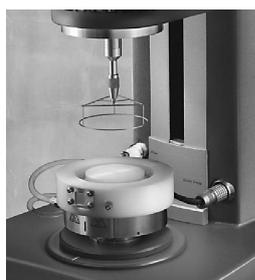
界面とはある均一な気体、液体や固体の相が他の均一な相と混ざり合わずに接している境界のことです。コロイド系で重要な特徴の一つとなります。従来より、レオメーターは物質のバルク特性を解析するために使用されてきました。医薬品、食品、パーソナルケア製品、コーティングなどの多くの物質には、明らかにレオロジー的な性質を持つ2次元液/液、あるいは気/液相があります。ナノトルク感度を有する AR-G2 KG とダブルウォールリング（DWR）システムとを組み合わせることで、より高精度な界面の粘弾性測定が可能となりました。
