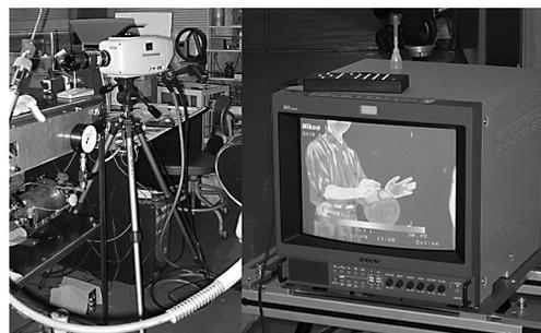
に10ns~20 $\mu$ s の範囲で1 ns ステップで設定可能。撮影フレーム間隔は40ns~320 $\mu$ s の範囲で5 ns ステップで任意に設定可能。レンズはニコン F マウント。撮影はポラロイドフィルムを使用。
