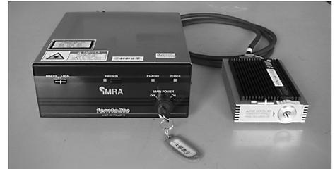
る。基本的に調整箇所と消耗品が無く、メンテナンス・フリーである。寸法はレーザーヘッドが145×98×40mm、制御装置が200×215×89mm で、質量は合計約 3 kg と小型で可搬である。同期信号出力端子（SMA）より、レーザー繰り返し周波数に同期した電気パルス信号が出力されている。リモートコントロールコネクタを介して、レーザー出停止、インタロック、レーザー出射状態のモニターができる。
