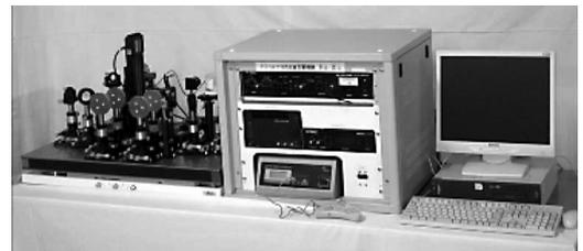
本テラヘルツ分光走査型顕微鏡の特徴を以下に記す。標準的には透過型のテラヘルツ分光走査型顕微鏡であるが、光学系の配置と制御ソフトウェアによって、空間分解の要/不要、透過型/反射型の計測ができる。具体的には、試料によって、空間分解しない/2次元走査/3次元走査と透過/反射が選択できる。光学系の配置を変更する際にはレーザーの精密な調整（<10ミクロン）が必要となるが、その為のレーザーのアライメントモジュールが用意されている。
