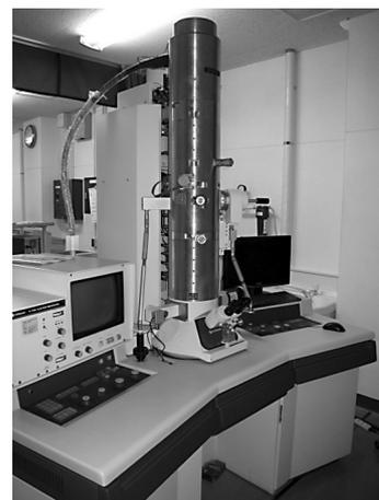
TEMで可能な観察方法には、通常の明視野像、試料によって散乱された電子線のみを結像させる暗視野像、さらに電子線を絞って試料に走査して像を得る走査透過像（STEM）等がある。試料が結晶質であれば、結晶からのブラッグ反射を結像させると電子線回折像が得られ、これは結晶相の同定や結晶方位の決定などに用いられる。JEM-2100では、実像と回折像がよく調和するようにコンピュータで制御されている。
