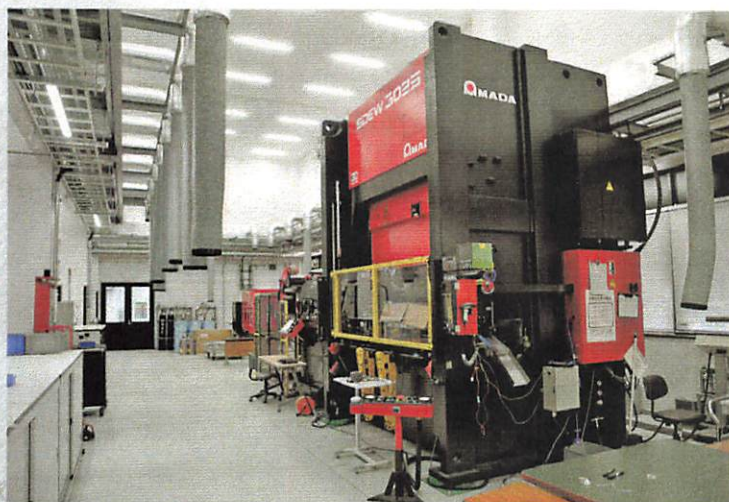
親しみを込めて「工場」と呼ぶセンター内には最新の300tプレス機や射出成形機、金属積層造形機が並ぶ
